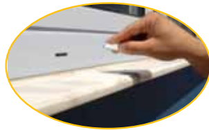
Su tahliye kapağının sökülmesi
